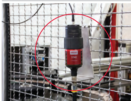
Lubrificação automática de uma guia deslizante
